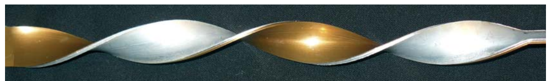
Abb. 2: gleichmäßiger, fehler- und grenzflächenfreier Gefügeübergang an laserwalzplattierten Al-Cu-Bändern (oben Grenzfläche im Detail, rechts Bauteil) (Quelle Fraunhofer IWS)
